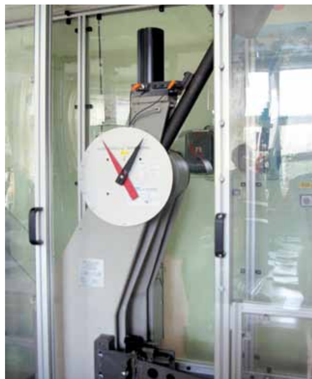
➤ Маятниковый копер PH-300 для определения работы удара по ГОСТ и ASME
