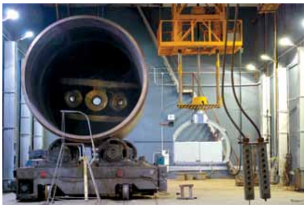
⤴ Линейный ускоритель электронов УЭЛ-6-Д. Предназначен для радиографического контроля толстенных изделий пучком тормозного излучения
