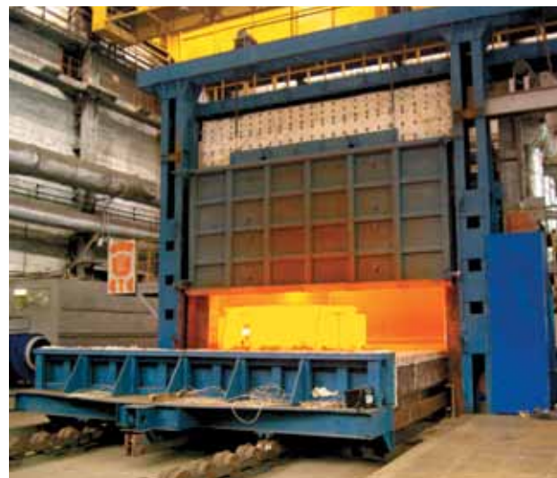
Ширина печи – 5,2 м, высота – 2,4 м, длина – 7,5 м. Максимальная температура – 1200°C
