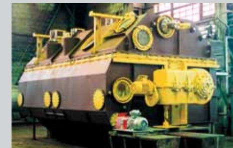
⬆ Фильтр барабанный герметизированный типа БГН для процесса депарафинизации на НПЗ
