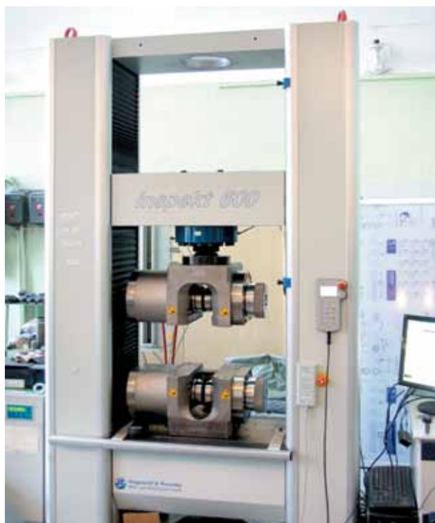
➤ Универсальные испытательные машины INSPECT 600 и INSPECT 100 с высокотемпературной печью до 1200°C для определения механических характеристик
