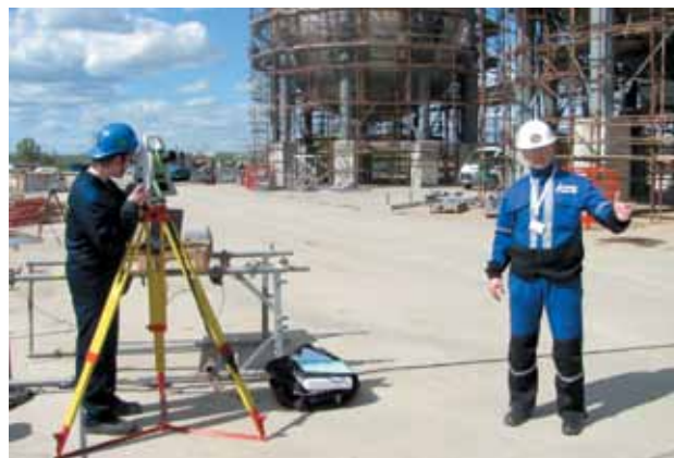
⤴ Тахеометр Leica TDRA 6000. Высокоточный инструмент, осуществляющий геометрические измерения в пространстве и математическую обработку данных
